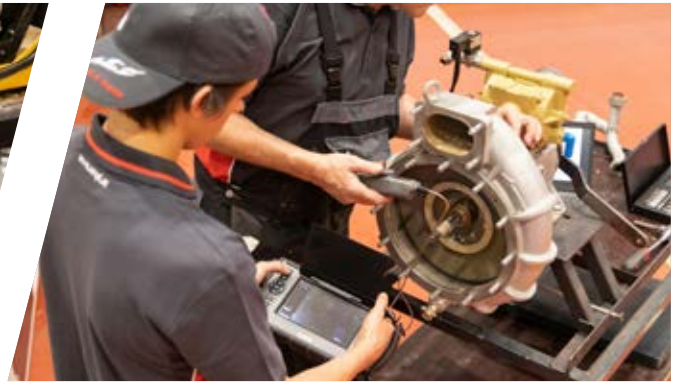
Inspektion einer Pumpe auf Beschädigungen mittels Kamera
