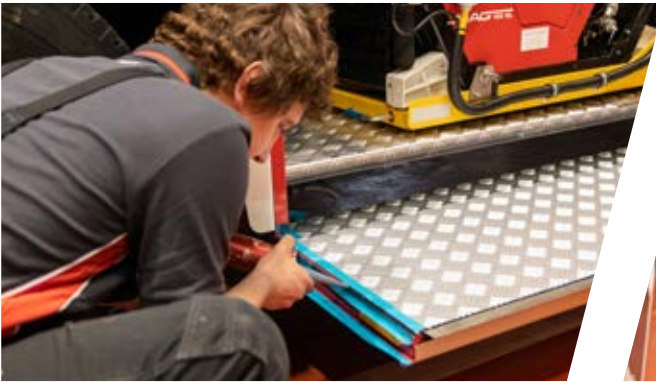
Abdichtarbeiten bei Instandsetzung eines Unfallschadens
